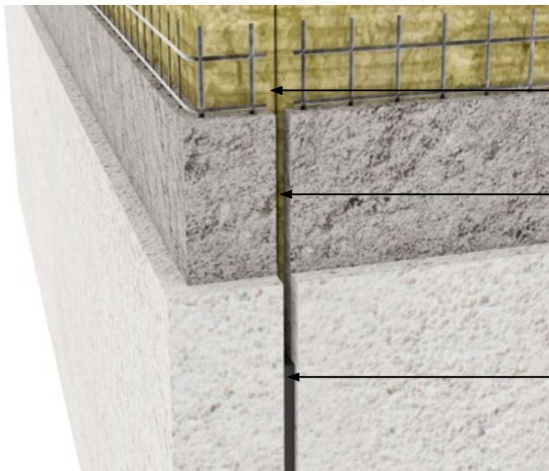
Rörelsefog med expanderande fogband, vid utåtgående hörn.
