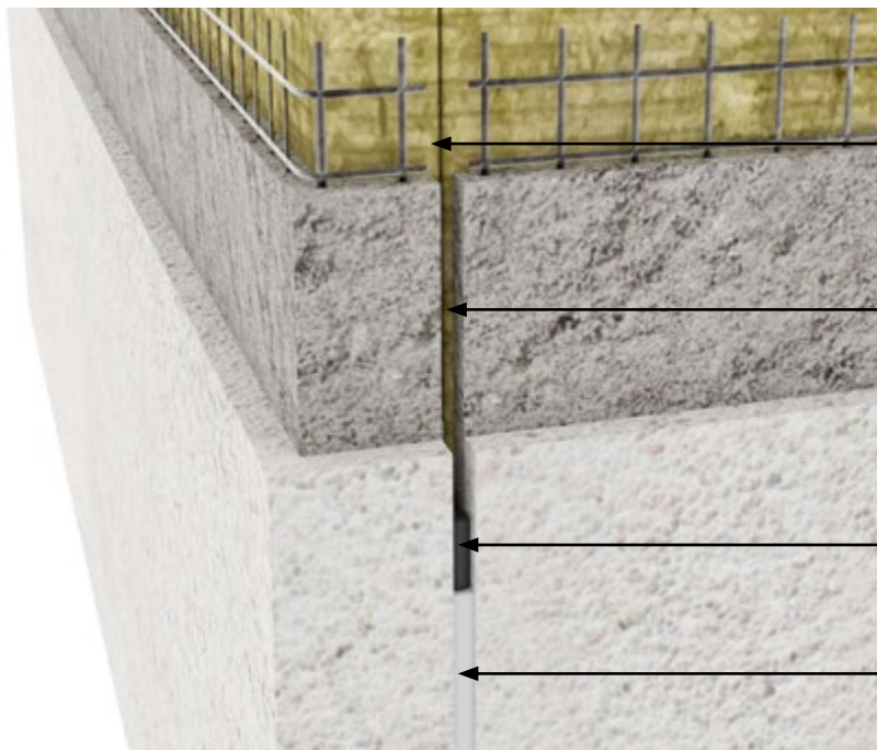
Rörelsefog med bottningslist och fogmassa, vid utåtgående hörn.
