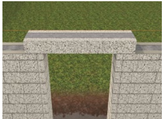
Mura Murbalk Exakt över öppningar för att bära upp kommande skift.
