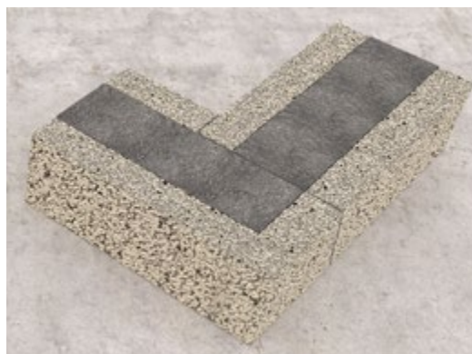
Kapa ena blocket vid en hörna för att bryta köldbryggan.
